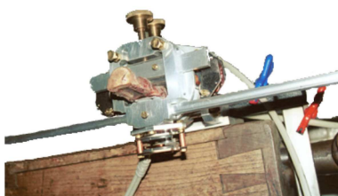
Obrázek 1.13: Celkový pohled na měřící aparaturu se vzorkem ovčí ploténky.
