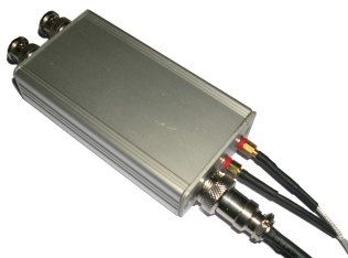
Obrázek 1.4: Kompletní podoba nábojového předzesilovače umožňuje být jako redukce připojena přímo na DRAK5 bez nutnosti použití dalších součástek, např. propojovacích kabelů.
