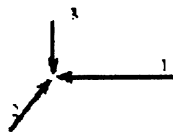
Obr. 9 Klasifikace zlomových struktur na základě vzájemného pohybu dílčích ker – reverzní zlom (Ramsay, 2002)
