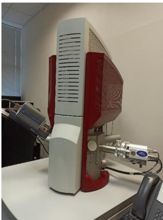
Obrázek 11: Řádkovací elektronový mikroskop Tescan MIRA 3 použitý v experimentu.
