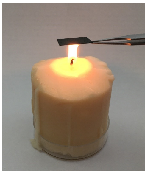
Obrázek 15: Depozice sazí na vzorek.
