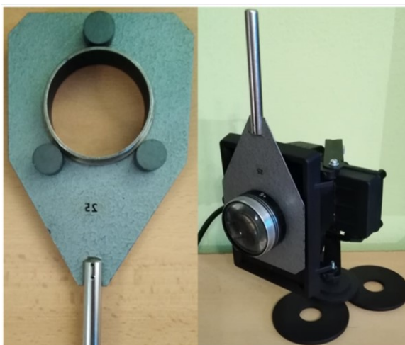
Obr. 2: Uchycení magnetů na držák čočky a držák s čočkou umístěný na reflektor
