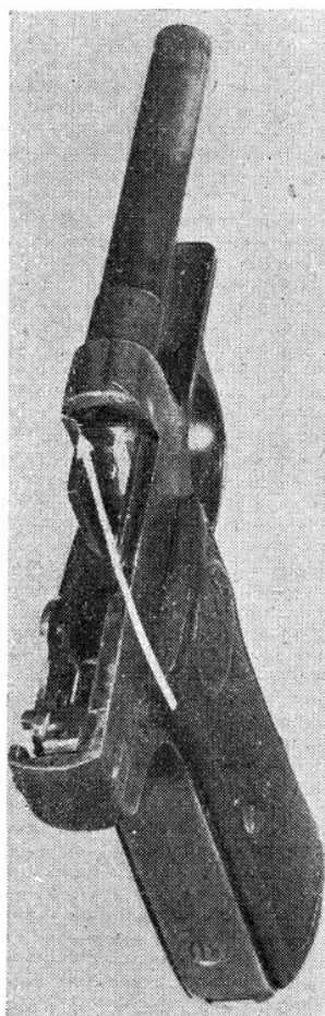
Obrázek 31: Tělo pistole Václava Mrázka, šipkou je označena hrana nábojové komory, která vytvářela sešinité stopy na obrubě dna nábojnic. 250
