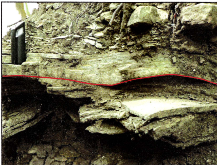
Obr. 23B: Ukázka vlnových čeřin v jemnozrnných pískovcích /víčko má 4,5cm/
