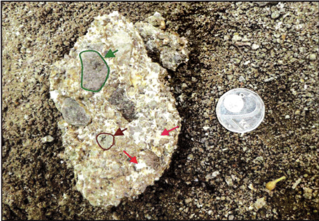
Obr. 24: Příklad aluviálního jemnozrného konglomerátu. Hnědá šipka ukazuje na více pozměněný bazaltoid, zelená šipka ukazuje na méně pozměněný bazaltoid. Prostor mezi klasy je vyplněn štěrčkem až velmi hrubým pískem s povlaky kalcitu znázorňují červené šipky.
