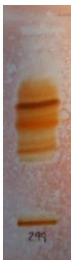
Obrázek 22: Tenkovrstvá chromatografie frakce VM 299, Silikagel Kieselgel 60 GF254 Merck, cHx + CH 3 COCH 3 + Et 2 NH (75 : 25 : 2), detekce Dragendorffovo činidlo
