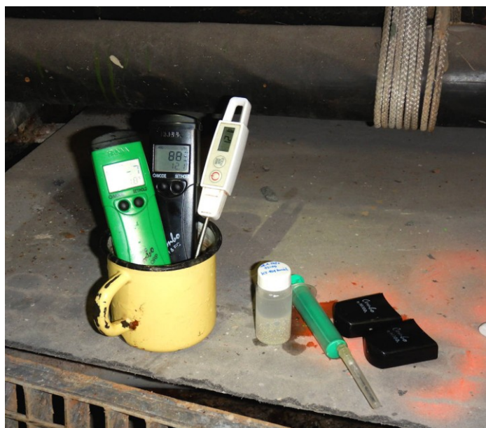
Obr. 4. Přístroje použité pro měření fyzikálních parametrů vod a scintilační lahvička s odebraným vzorkem pro měření aktivity ^{222}\text{Rn} a ^{226}\text{Ra} , foto V. Goliáš, 28. 1. 2020.
