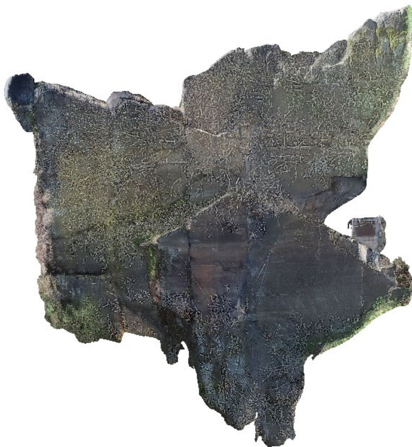
Příloha 3: Model vytvořený z dat laserového skenování a filtrován manuální metodou
