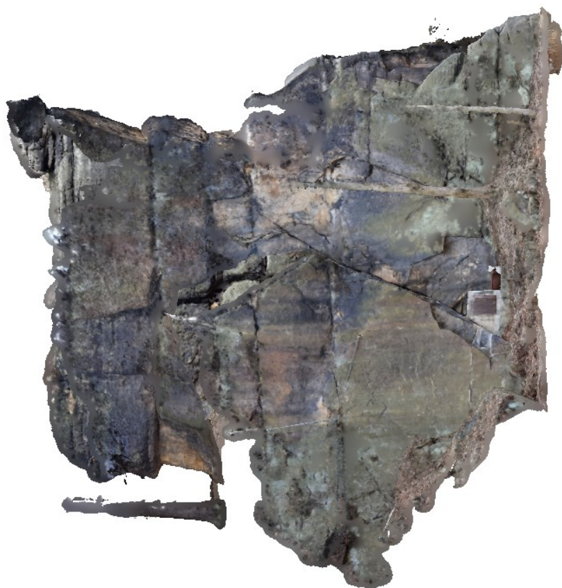
Příloha 4: Model vytvořený z dat pozemní fotogrammetrie a filtrován navrženou metodou
