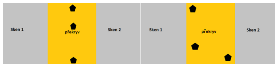
Obr. 8: Špatné (vlevo) a dobré (vpravo) umístění spojovacích bodů
