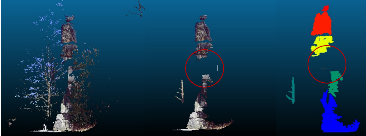
Obr. 61: Sken 4 před a po DBSCAN filtraci (vlevo: před klastraci, uprostřed: po klastraci, vpravo: vytvořené klastry)
