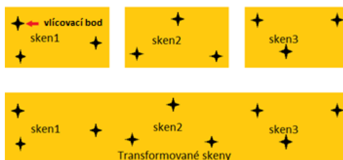
Obr. 9: Princip jednofázového georeferencování (nahore: skeny před georeferencováním, dole: skeny po georeferencování)
