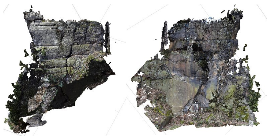
Obr. 54: Husté bodové mračno z pozemní fotogrammetrie
