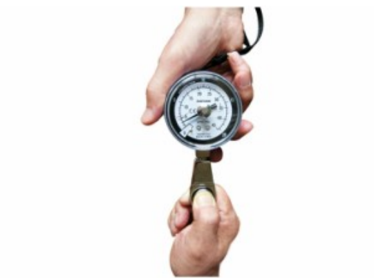
Obrázek 5: Testování klíčového úchopu
