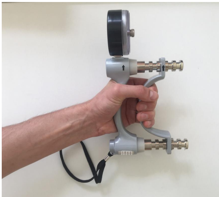
Obr.14. - Dynamometr (nahore) – Pro správné provedení testu je nutné nastavit dynamometr do správné velikosti. Střední část dynamometru lze vyjmout a posunout do požadované polohy. Tlak má být vyvíjen v thenarové části dlaně a na druhém článku prstů. Pacient následně stiskne dynamometr, na stupnici se ukáže vyvinutý tlak v jednotkách váhy, konkrétně kilogramy. Je též žádoucí, aby byla pacientova ruka suchá, nabídneme tedy papírový ubrousek k odstranění přebytečného potu a mastnoty.
