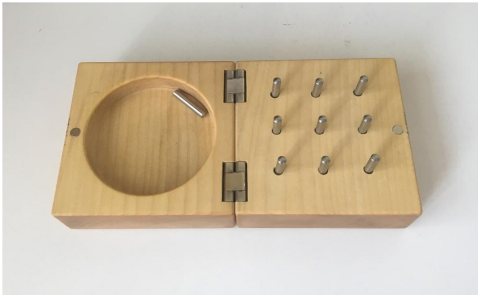
Obr.13- Nine-Hole-Peg Test (na začátku testu je v levé části krabičky umístěno 10 kovových kolíků. Pacient má 9 z nich umístit do zdířek v pravé části v libovolném pořadí a následně je opět přemístit zpět do levé části. Pokud jeden kolík upadne, test pokračuje. Při druhé chybě je test ukončen, popřípadě zopakován. Čas měříme od chvíle, kdy se pacient dotkne prvního kolíku a stopujeme ve chvíli, kdy je poslední kolík zpět v levé části krabičky.
