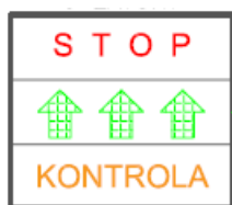
Obrázek č. 9 Dopravní světelné návěští jízdního pruhu
