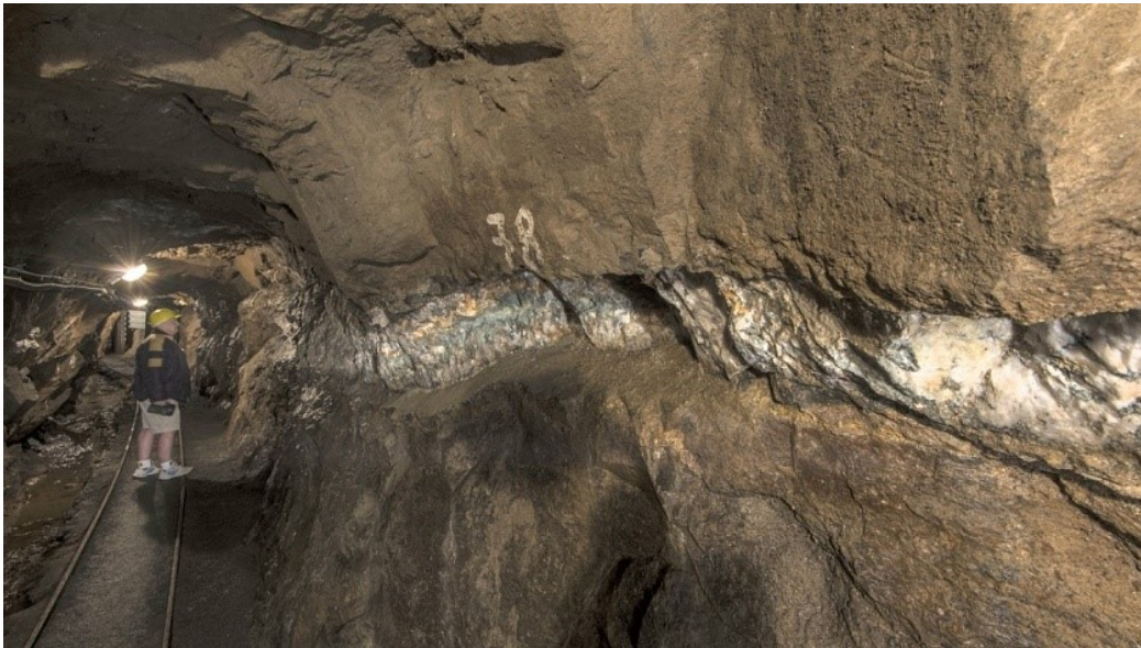
Obrázek 18 - Křemenná žíla Lukáš je jednou z největších cínonosných žil ve střední Evropě, ve štolě Starý Martin dosahuje mocnosti kolem 35 cm (Foto: Petr Mikšíček)
