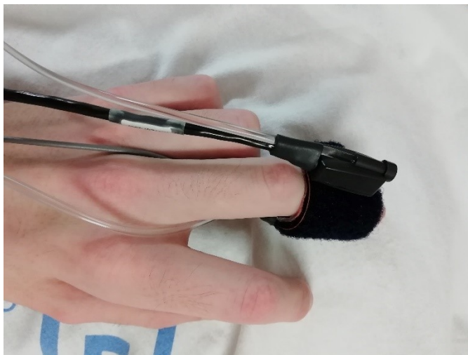
Obrázek 3: Prstová manžeta s připnutou spodní částí jednotky korekce výšky (vlastní zdroj)
