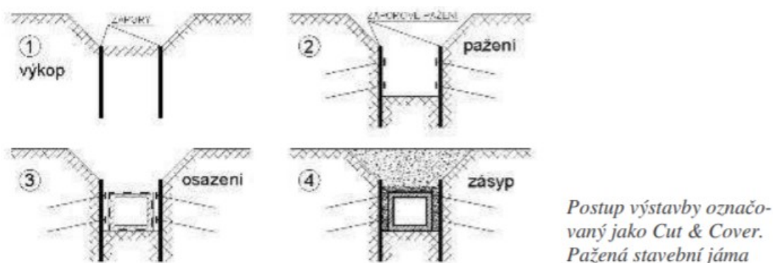
Obrázek 6 Postup stavby Cut & Cover (Horák, 2007)
