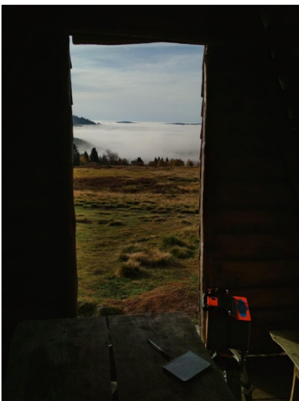
Obrázek 3: Gravimetr Scintrex CG-6 umístěný na základním bodě ZB2. I přes dřevěnou konstrukci přístřešku bylo rušení minimální i ve větrném počasí.
