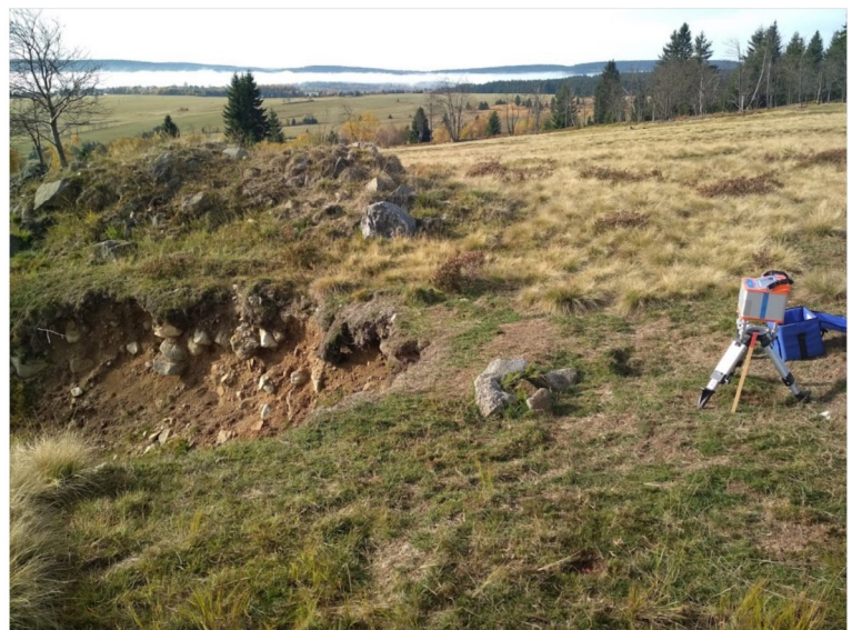
Obrázek 4: Gravimetr Scintrex CG-6 na profilu P7. Vlevo je jáma vzniklá pravděpodobně při předchozím pátrání po štolě.
