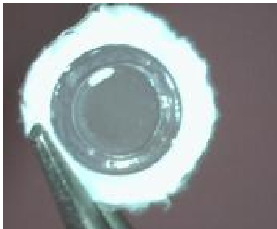
Obr. 8: PTFE membrána po průtoku mobilní fáze o rychlosti 0,2 \text{ ml}\cdot\text{min}^{-1} , pohled shora. Na této fotografii je zobrazena membrána bez dalších deformit.
