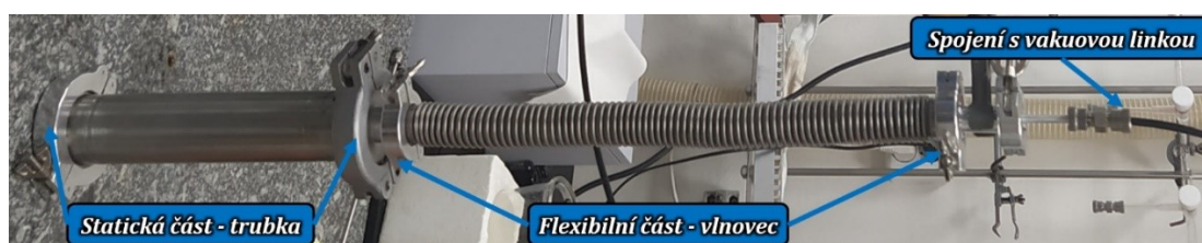
Obrázek 26: Experimentálně sestavený inkubátor složený ze spodní pevné části a vrchní flexibilní části, tvořené vlnovcem. Inkubátor je vakuově propojen s vakuovou linkou
