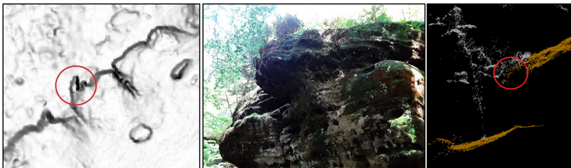
Obr: 35: Ukázka chybně provedené manuální filtrace dat.
