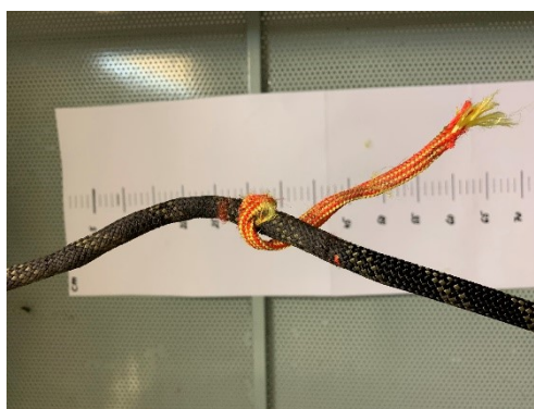
Obrázek 29 Přitavení Reep šňůry k lanu
