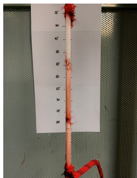
Obrázek 25 Selhání opletu lana při měření dvojitého Prusíkova uzlu
