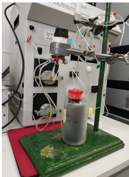
Obr. 4: Použitá aparatura pro modelový experiment na AFS, vlastní fotografie
