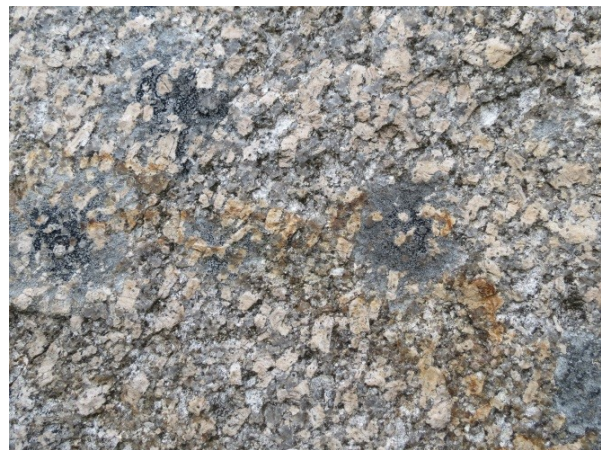
Foto 12. Planární přednostní orientace vyrostlic draselného živce se strmou orientací ve výrazně porfyrickém granitu jizerského typu. Pohled k západu, rozměr spodní hrany 50 cm.
