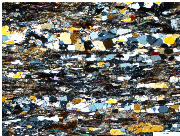
Foto 6. Mikrofotografie kontaktního fylitu v polarizovaném světle s páskovanu texturou. Měřítko 0,5 mm.
