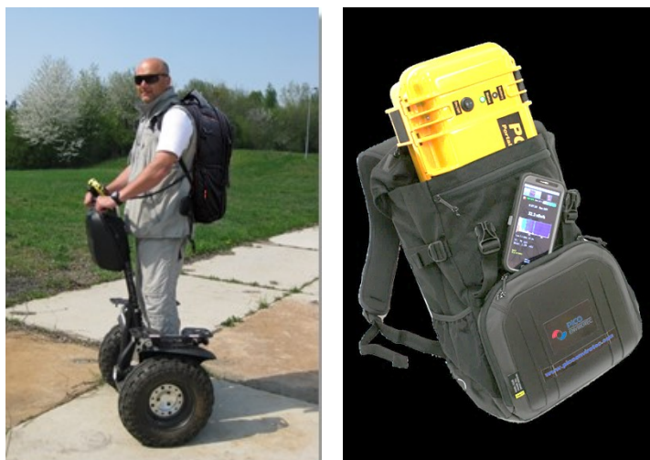
Obr. 1. Gamaspektrometr PGIS-2/Backpack v geometrii měření 2 m nad zemí (Nuvia Dynamics, 2018).
