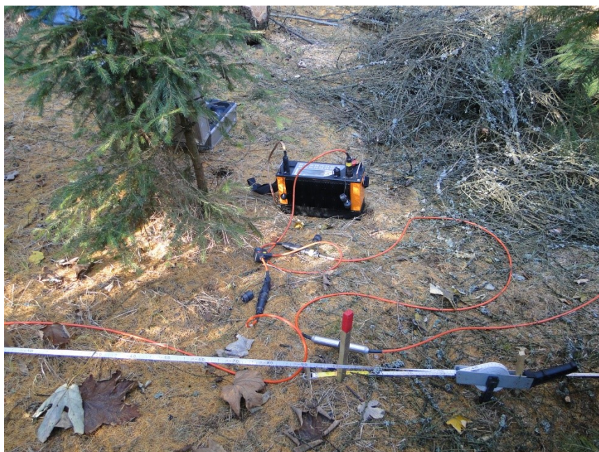
Obr. 6. Elektrická odporová tomografie měřená přístrojem Ares (GF-Instruments) na lokalitě Dolní Černá Studnice.
