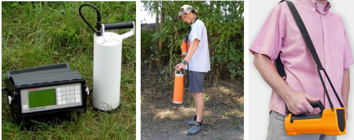
Obr. 2. Gamaspektrometr GR-320 v geometrii měření na zemi (vlevo), přístroj GS-256 v geometrii měření v 0,5 m (uprostřed) a přístroj GT-32 (Georadis, 2018) v geometrii měření v 1 m nad zemí (vpravo).
