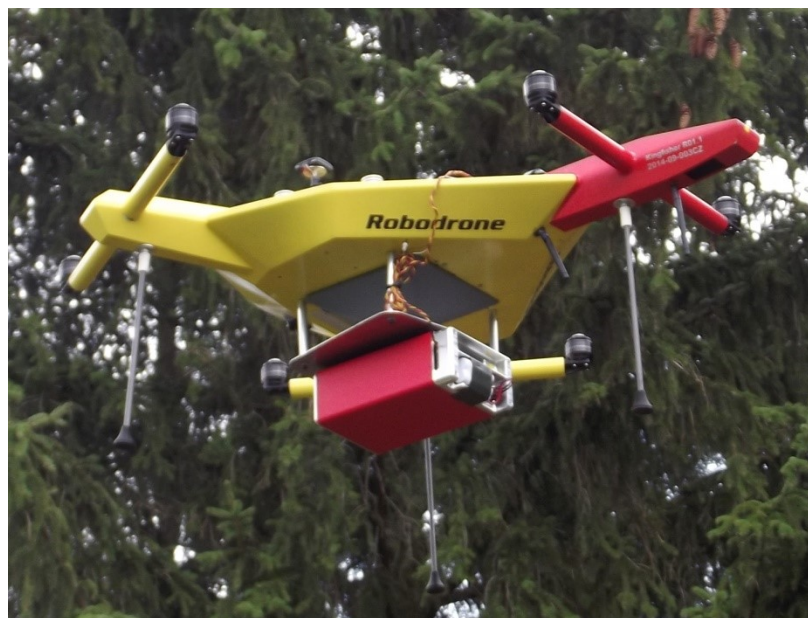
Obr. 13. Hexakoptéra Kingfisher s připojeným gama spektrometrem D230A v letu.
