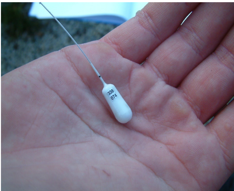
Obr. 3: Vysílačka použitá k označení ryb (Foto: Pavel Horký)
