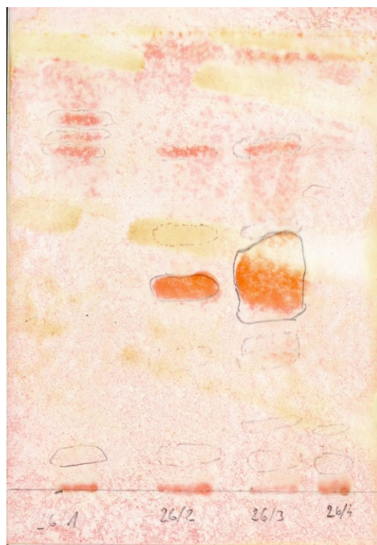
Obrázek 21: Kontrolní chromatogram čtyř podfrakcí, které byly vytvořeny dělením frakce 26. Podle tohoto chromatogramu byly vybrány frakce pro následné dělení.
