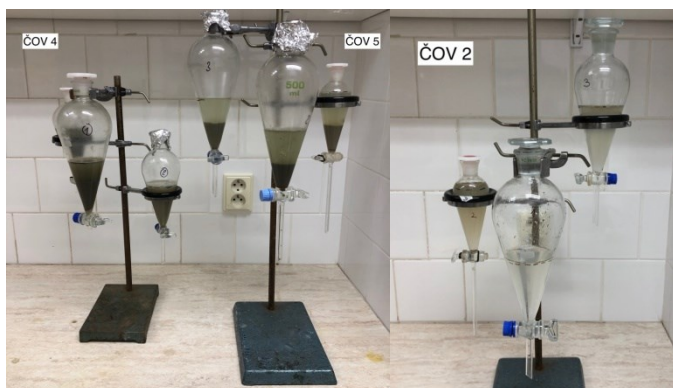
Příloha č. 7 vlevo: První sedimentace vzorků kalů s vysokým obsahem usazenin u dna nálevek; nalevo lze vidět neusazené vzorky z ČOV 4, napravo usazené vzorky z ČOV 5
