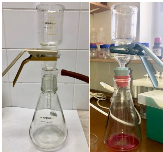
Příloha č. 5 vlevo: Aparatura na vakuové odsátí tekutiny ze vzorků kalů po sedimentaci v dělicích nálevkách
