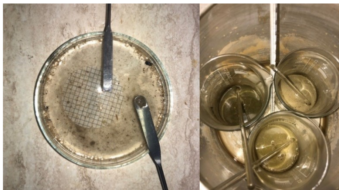
Příloha č. 3 vlevo: Příprava vzorku kalu ke druhé sedimentaci, čištění usazenin na filtračním papírku roztokem NaCl
