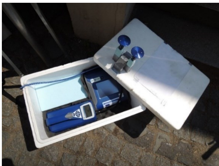
Obr. 2: Otevřený box s přístroji P-Trak a DustTrak DRX umístovaný na řídky cyklistického kola.
