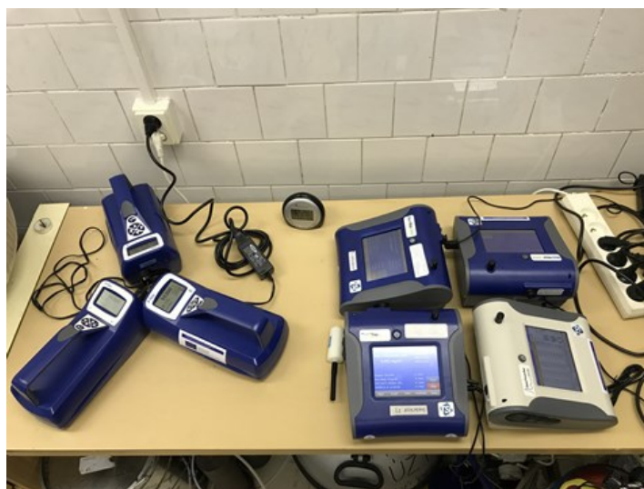
Obr. 1: Kolokace přístrojů DustTrak, P-Trak a OPS v laboratoři Ústavu pro životní prostředí.
