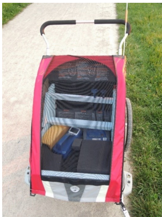
Obr. 3: Vozík s přístroji P-Trak a DustTrak DRX, zde s ochrannou sítíkou.
