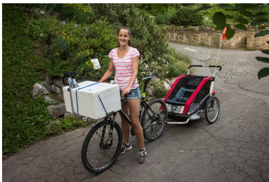
Obr. 4: Jízdni souprava cyklistického kola a přívěsného vozíku s měřicími přístroji.
