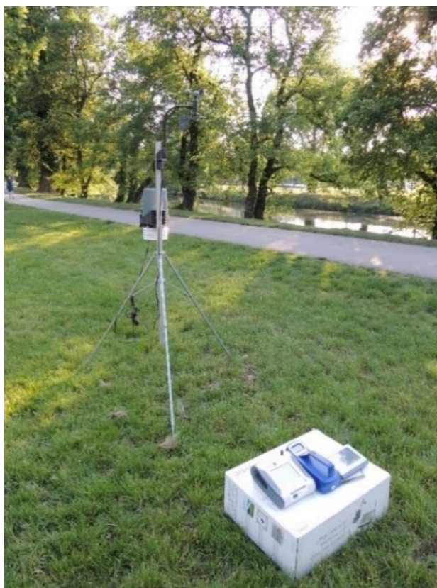
Obr. 5: Meteorologická stanice Oregon Scientific (model WMR 300) a přístroje P-Trak a OPS v lesoparku Stromovka (50.1077N, 14.4125E).
