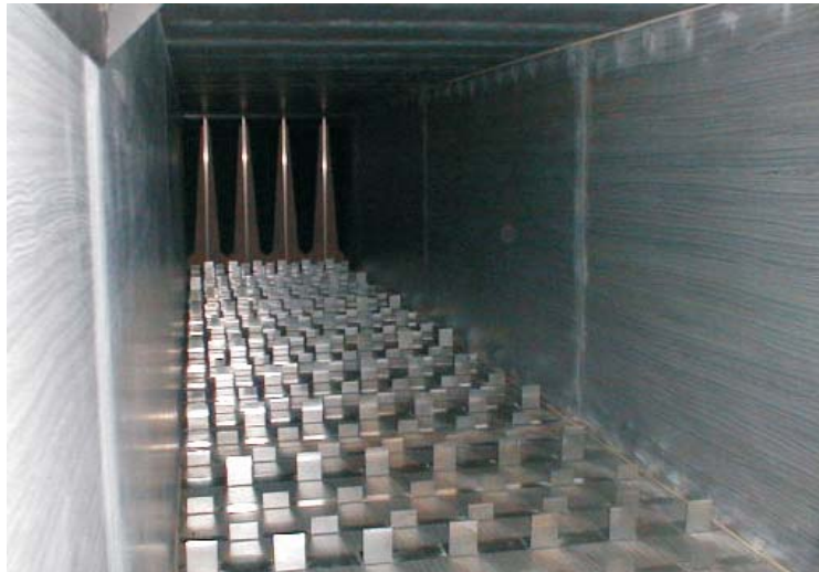
Obrázek 2.2: Pohled do aerodynamického tunelu proti proudu vzduchu. Vpředu elementy drsnosti na podlaze aerodynamického tunelu, v pozadí generátory turbulence ve vstupním otvoru proudovodu (převzato z [7]).
