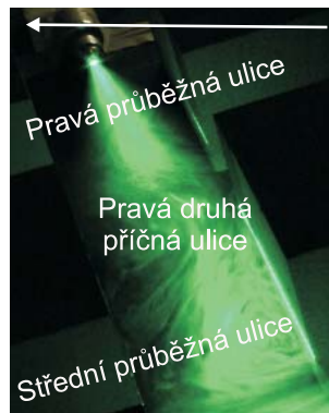
Obrázek 4.5: Dominantní proudění v druhé pravé příčné ulici při úhlu natočení \varphi = +10^\circ (pohled zleva shora).
