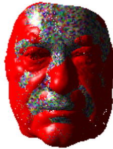
Obrázek 7.1.2: Zobrazuje překrytí dvou různých tváří, barevná je původní tvář, červená je druhá načtená
