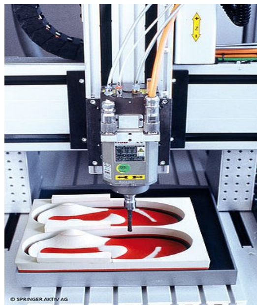
Obrázek 28 Springer vložky CNC fréza (zdroj online: Dostupné z https://www.proprio.info )
