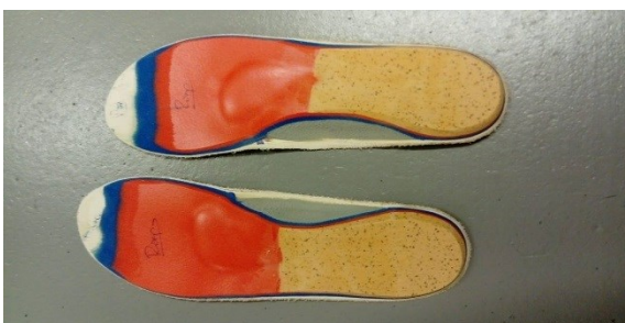
Obrázek 24 Výroba ortopedických vložek-broušení (zdroj vlastní)
