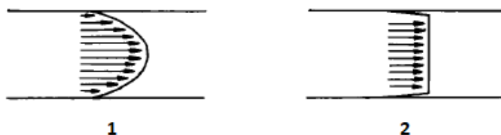
Obrázek 1: Typy proudění. Při proudění kapaliny vyvolaném tlakem prochází kapalina s parabolickým profilem (1). Proudění za působení elektroosmotického toku (2) je pravoúhlé. Kapalína tak proudí kapilárou ve všech místech se stejnou rychlostí. Převzato z [2] a upraveno.
