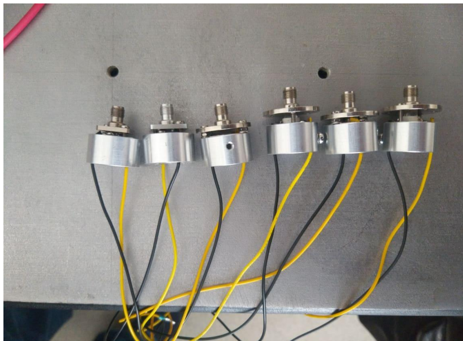
Obr. 5: Supersvítivé diody namontované do koncovek kompatibilních s optickou kabeláží s chladiči
