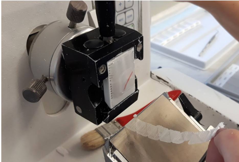
Obrázek 9: Rotační mikrotom – zhotovení parafinových řezů (foto autora, Laboratoře Agel a.s., Laboratoře patologie 2019).
