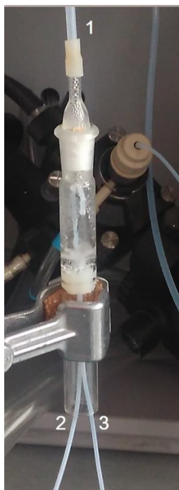
Obr. 14.: Fotografie separátoru fází. 1 – výstup ze separátoru fází do atomizátoru, 2 – odtah kapalně fáze do odpadu, 3 – přívod reakční směsi se vzorkem z reakční cívky.
