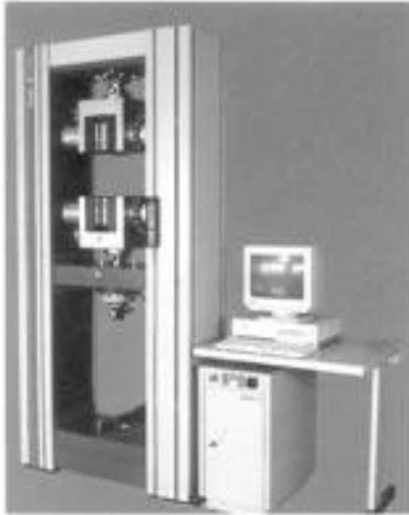
Obr. 6: Materiálový zkušební stroj T1-FR050TH.A1K firmy Zwick/Roell
