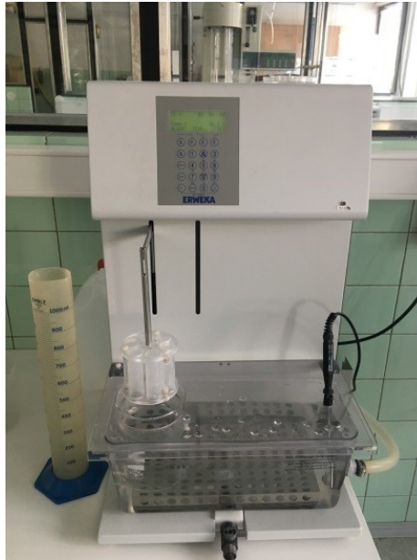
Obrázek č. 11 Rozpadostroj ERWEKA, model ZT301
