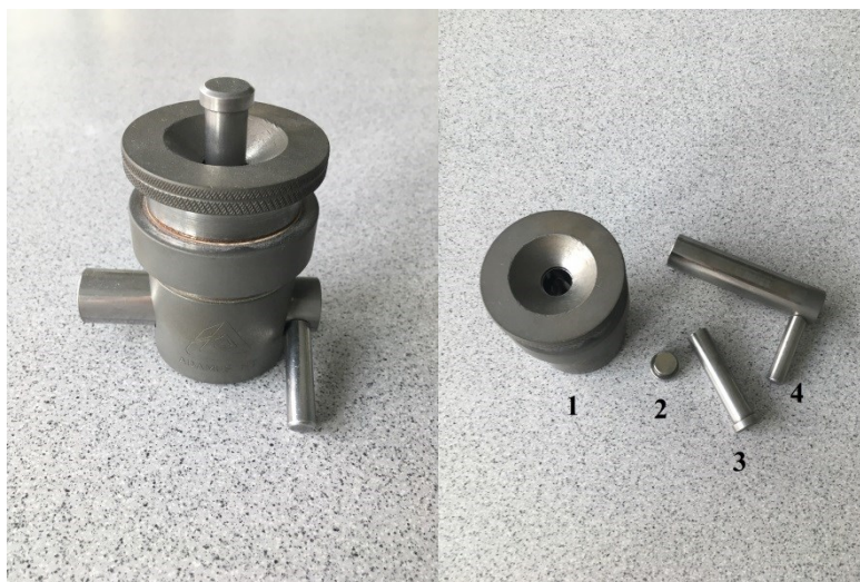
Obrázek č. 12 Lisovací přípravek Adamsu HT - 1 vnější plášť s matricí, 2 dolní lisovací trn, 3 horní lisovací trn, 4 zajišťovací část
