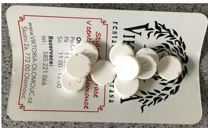
Obrázek č. 23 Laktosa LA 158 \mu\text{m} 8 kN
