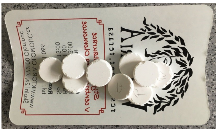
Obrázek č. 24 Laktosa LA 158 \mu\text{m} 10 kN
