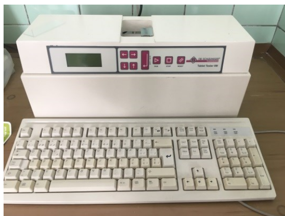
Obrázek č. 8 Dr. Schleuniger® Pharmatron tablet hardness tester, model 8M
