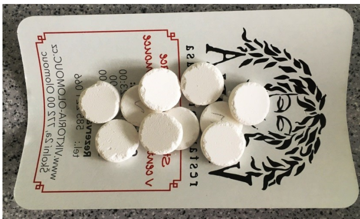
Obrázek č. 21 Laktosa LA 158 \mu\text{m} 4 kN
