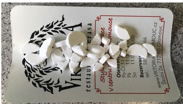
Obrázek č. 18 Laktosa T80 158 \mu\text{m} 10 kN
