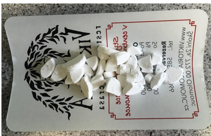
Obrázek č. 17 Laktosa T80 158 \mu\text{m} 8 kN
