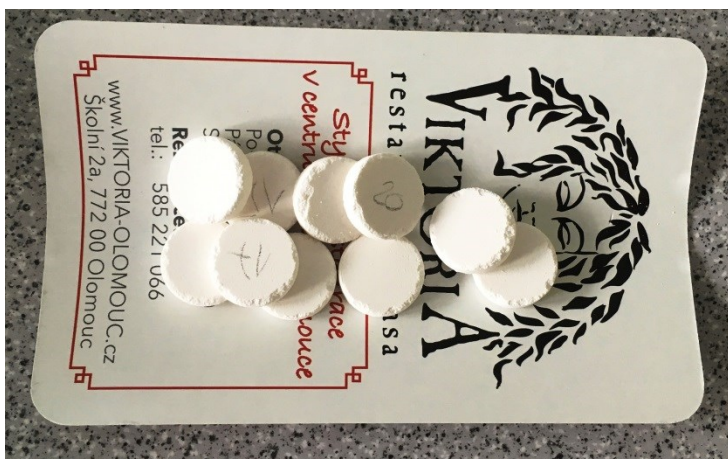
Obrázek č. 22 Laktosa LA 158 \mu\text{m} 6 kN
