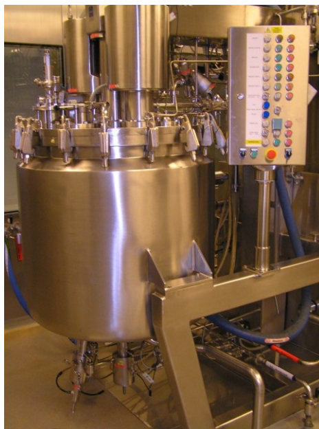
Obrázek 30: Výrobní kotel Fryma s kapacitou 3200l bulku (TEVA, 2018)
