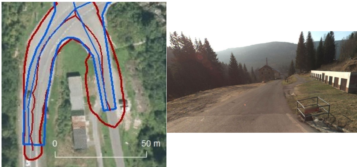
Obrázek 20 - zdánlivě nesprávně určené plochy (červená linie – plocha komunikace vymezená navrhaným postupem, modrá linie – plocha komunikace z dat KN)
