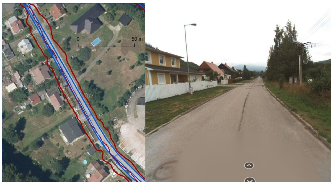
Obrázek 22 - vliv přilehlé zástavby na vymezení komunikace
