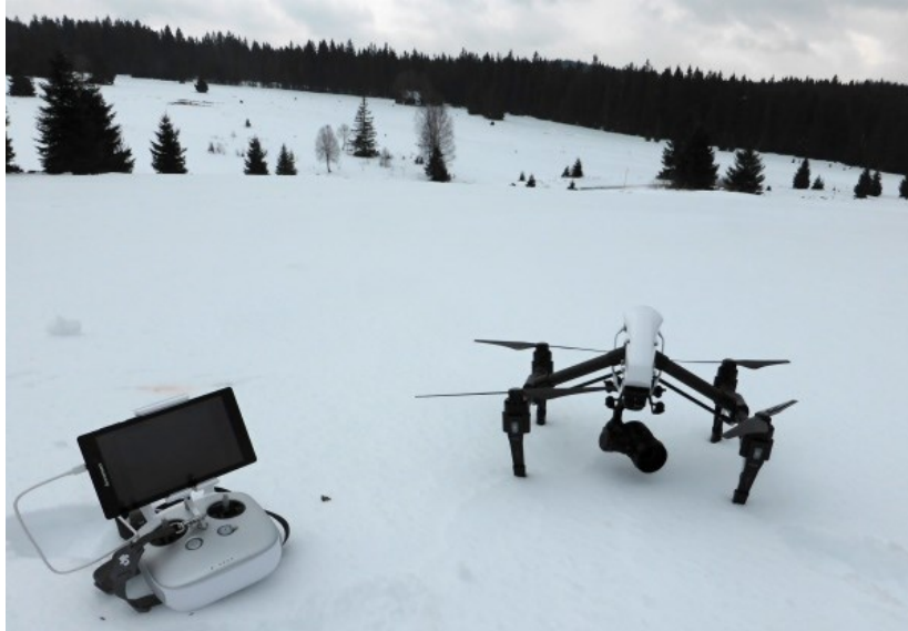
Obrázek 6.1: Vybavení bezpilotních systémů včetně fotoaparátu (Foto: Jakub Langhammer).
