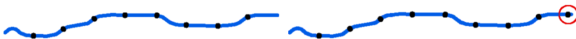
obr. 28 ilustrace segmentace linie vlevo - správná segmentace (po přepočtu), vpravo - chybná segmentace (bez přepočtu)
