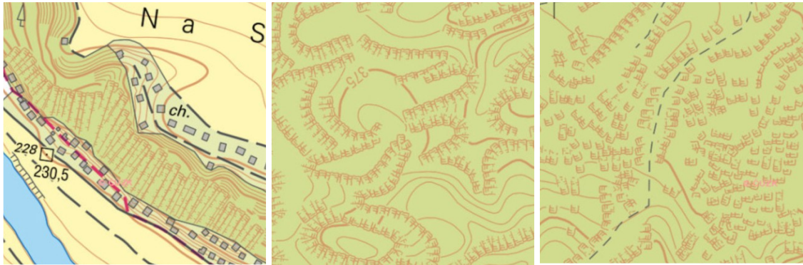
obr. 2 žebříčková manýra na Základní mapě 1 : 10 000 (mírně zvětšeno) vlevo - skalnatý sráz, uprostřed - pískovcová oblast NP České Švýcarsko, vpravo - pískovcová oblast Adršpašsko-Teplické skály Zdroj: © ČÚZK, 2019
