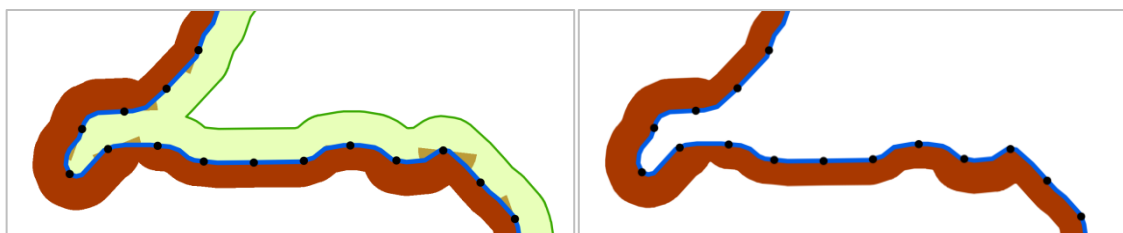
obr. 40 ilustrace „přečnívajícího“ polygonu bufferu vlevo - kontura přečnívající přes linii dolní hrany (zeleně - buffer pro odmazání), vpravo - výsledná podoba (po odmazání)
