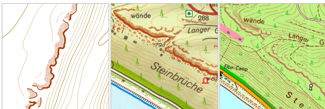
obr. 79 porovnání reprezentace při znázornění „jednoduché skalní stěny“ vlevo - výstup algoritmu, uprostřed - mapa Schrammsteingebiet, vpravo - DTK 10 Zdroj: Staatsbetrieb Geobasisinformation und Vermessung (2013), © GeoSN (2019)
