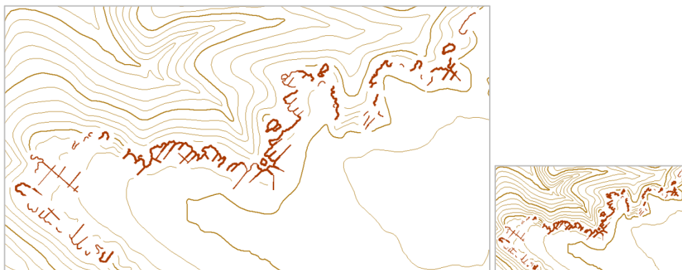
obr. 62 ukázka konturové metody dle parametrů v ACD vlevo - reprezentace vytvořena v měřítku 1 : 10 000, vpravo - reprezentace vytvořena v měřítku 1 : 25 000 ZIV 5 m
