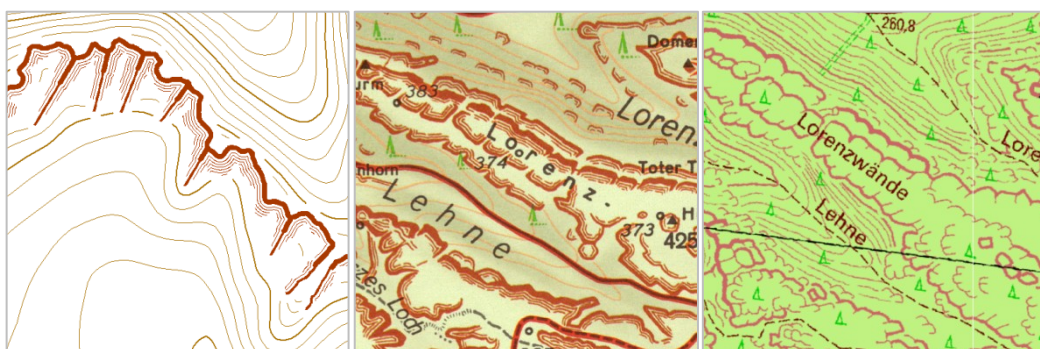
obr. 80 porovnání reprezentace při znázornění „rozčleněné skalní stěny“ vlevo - výstup algoritmu, uprostřed - mapa Schrammsteingebiet, vpravo - DTK 10 Zdroj: Staatsbetrieb Geobasisinformation und Vermessung (2013), © GeoSN (2019)
