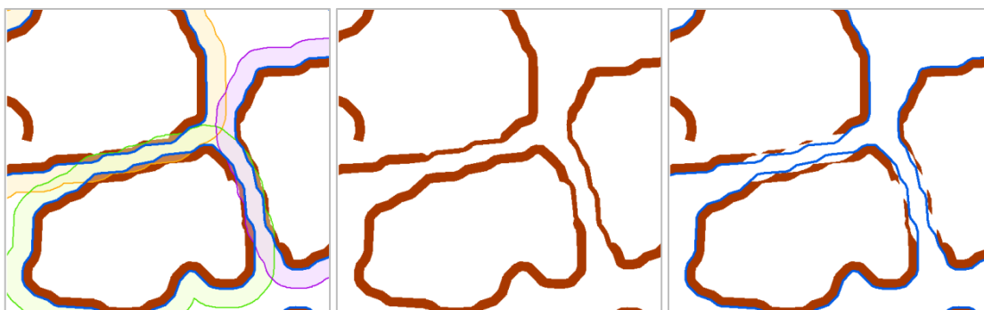
obr. 41 ilustrace nežádoucího odmazání linie kontury hnědě - kontura, modře - linie dolní hrany vpravo - barevně odlišené levostranné buffery jednotlivých dolních hran , uprostřed - požadovaný výstup (odmazávání prvek po prvku),
