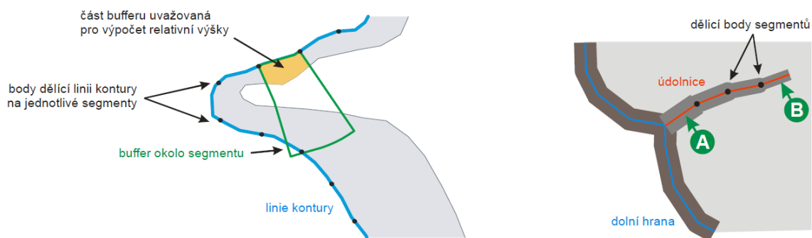
obr. 18 ilustrace k výpočtu šířky linií kontur a údolnic Zdroj: Lysák (2016)
