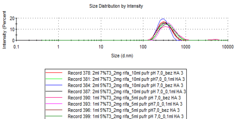
Obrázok 29 – Distribučná krivka veľkosti častíc pre vzorky č. 1 – 8 z kapitoly 10.2.7 pripravených metódou „drop-wise“ (súhrn)
