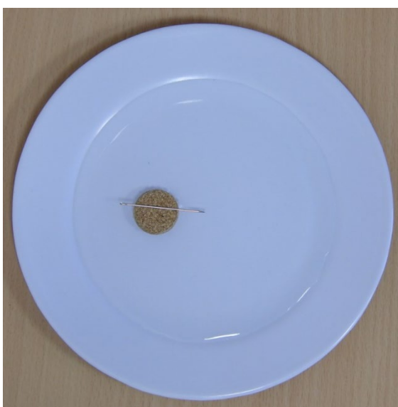
Obrázek 1: Hotový kompas plovoucí na talíři s vodou
