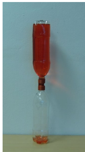
Obrázek 21: Pokud lahve otočíme, voda bez cizího přičinění do spodní lahve neteče.
