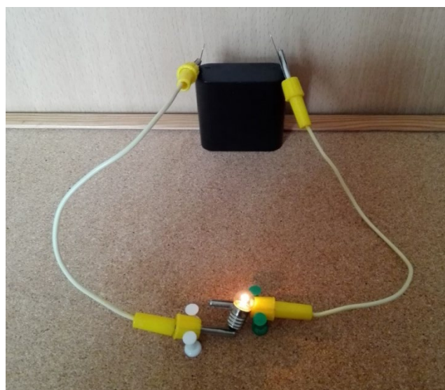
Obrázek 7: Baterie s obvodem z vodičů a žárovkou
