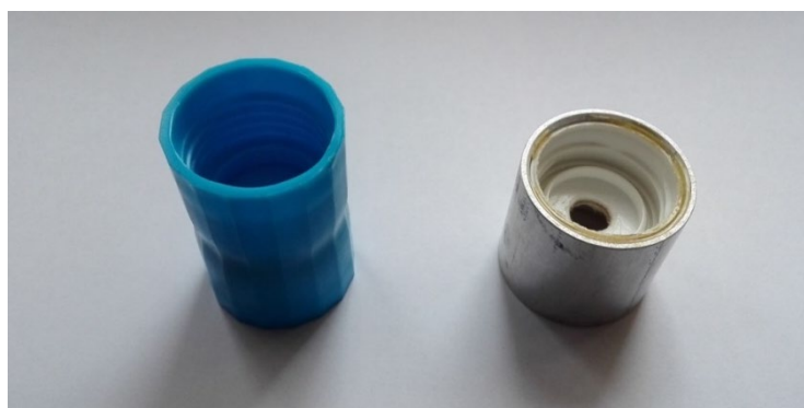
Obrázek 22: Komerčně vyráběný tornádovač (vlevo) a tornádovač vyrobený slepením dvou víček a zpevněním hliníkovou trubicou místo izolepy (vpravo)
