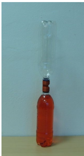
Obrázek 20: Lahve spojené „tornádovačem“. Jedna naplněna obarvenou vodou, jedna pouze plná vzduchu.
