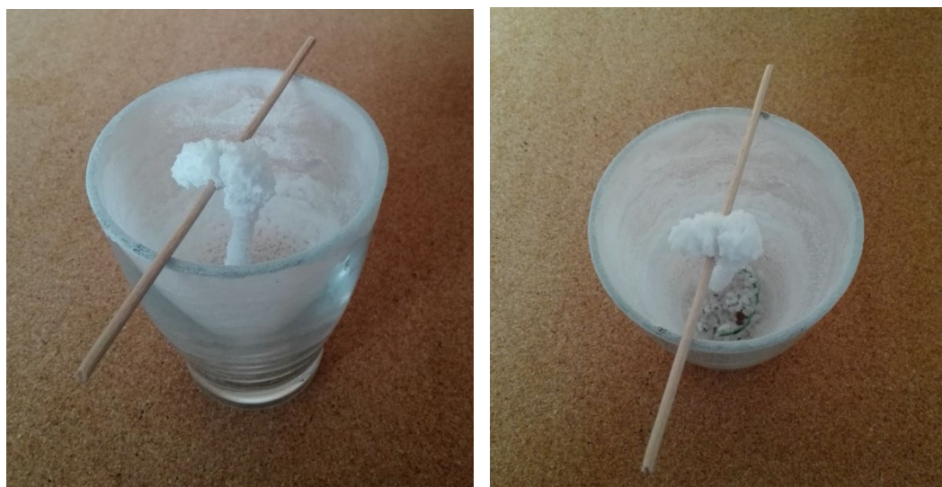
Obrázek 16: Sklenice po vypaření vody, část soli zůstala na stěnách, část na bavlnce a část vytvořila krystaly na dně sklenice
