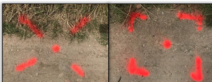
Obrázek 26 a 27: Terče použité v terénu – vlčovací bod (vlevo) a kontrolní bod (vpravo)
