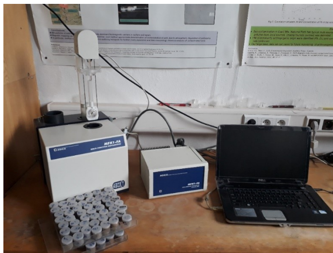
Obr. 5 - MFK1-KA Kappabridge (AGICO, Brno), geomagnetická laboratoř Geofyzikálního ústavu AV ČR.
