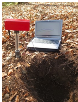
Obr. 4 - Vlevo je SM 400 (ZH Instruments, Brno), vpravo polní sonda MS2D (Bartington Instruments, Velká Británie) Zdroj: Grison H. (foto archiv 2018).
