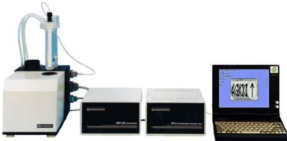
Obr. 6 - Kappabridge KLY- 4S ve spojení s teplotní aparaturou CS-3(AGICO, Brno)
