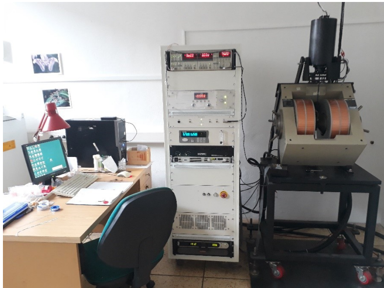
Obr. 7 - EV9 VSM (ADE Corporation, USA), geomagnetická laboratoř Geofyzikálního ústavu AV ČR.
