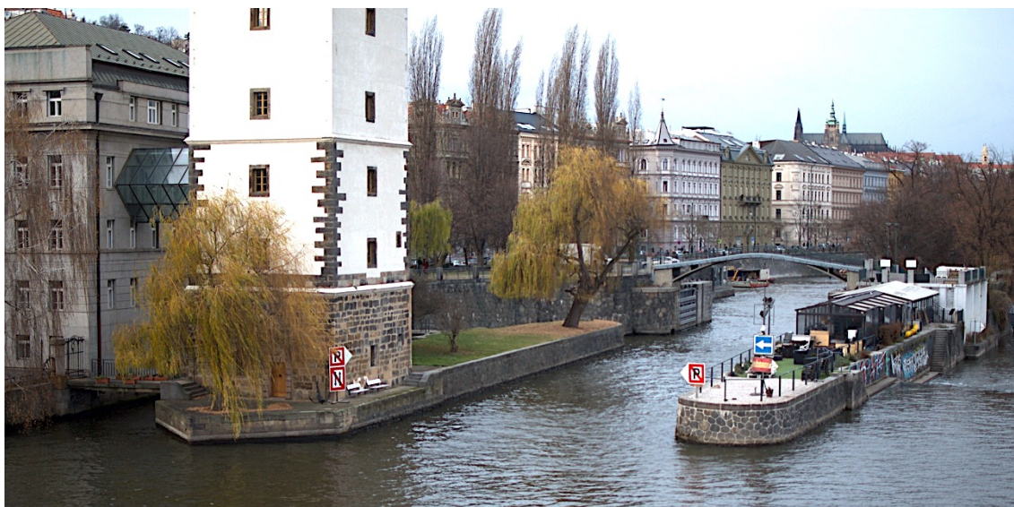
Obr. č. 17 Zprava: Zákaz parkování – Zákaz potkávání a předjíždění – Zákaz parkování – Doporučený směr plavby – zákaz proplutí vpravo. (Vlastní archiv, 2017)
