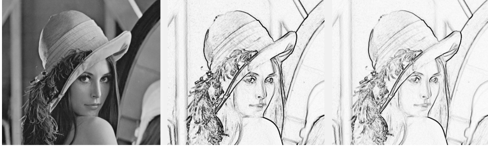
Obr. 3.3: Porovnanie hranových detektorov s rôznymi maskami. Zľava: originálny snímok, sobelov detektor hrán, prewittov detektor hrán [8].
