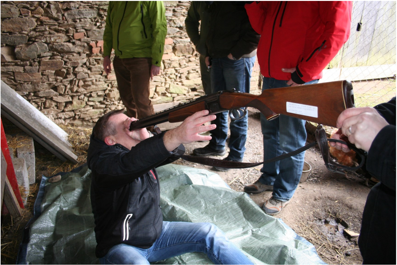
Měření při pozici poškozeného vsedě. Figurant vůbec nedosáhne na spoušť.
