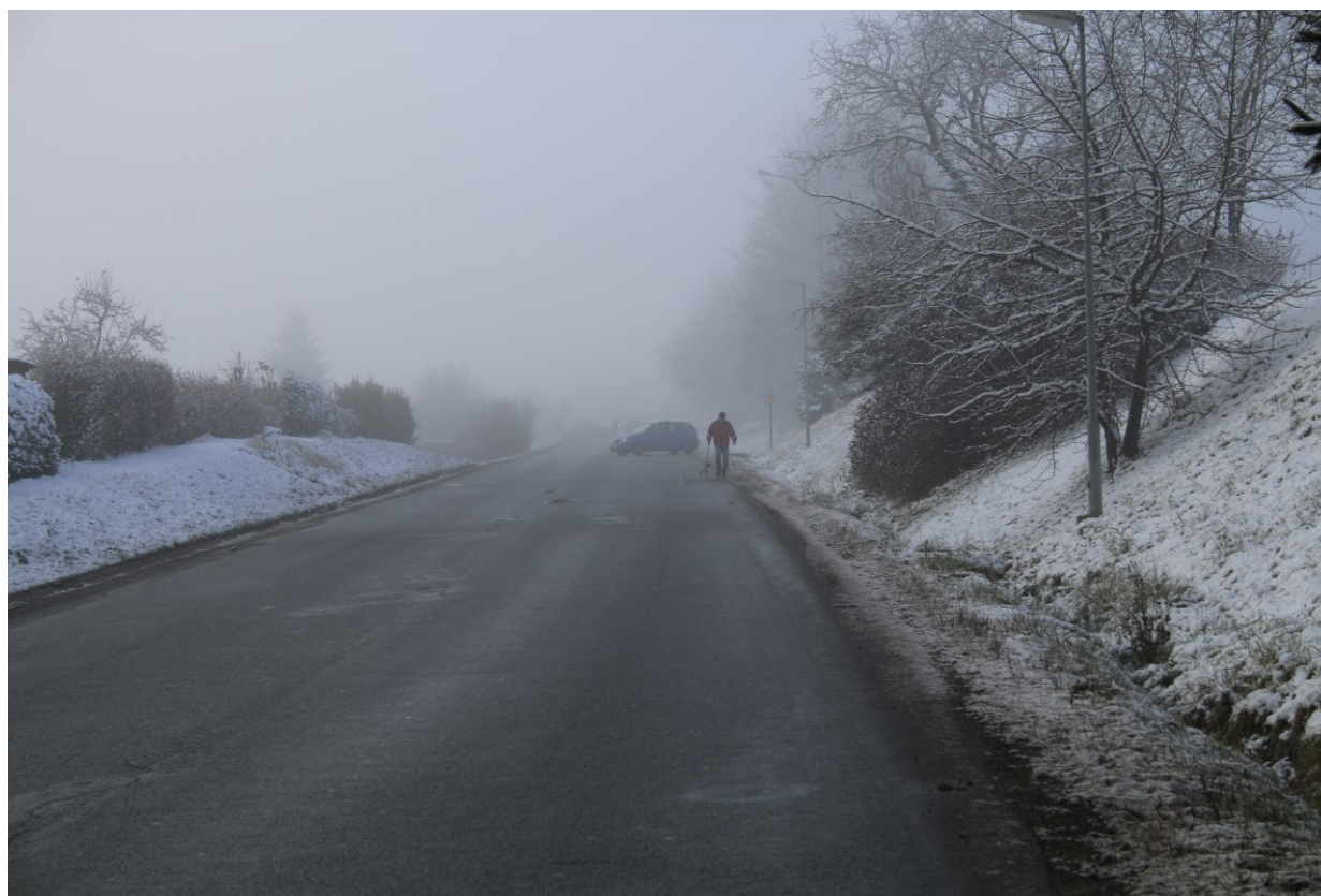
Simulování výhledu motocyklisty. Obrázek zachycuje okamžik, kdy motocyklista zaregistroval vozidlo v křižovatce (vozidlo, které mu nedalo přednost) a zaměření vzdálenosti motocyklisty od vozidla kolečkem.
