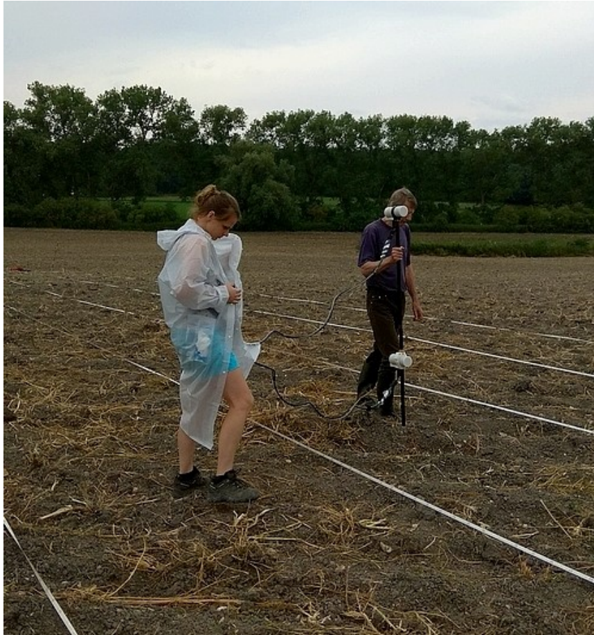
Foto 3: Měření gradiometrem GSM–196V (GEM Systems).
