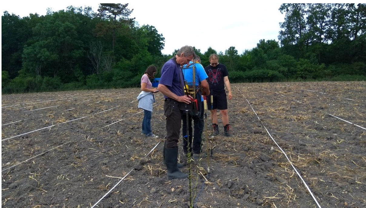
Foto 2: Měření metodou symetrického odporového profilování.
