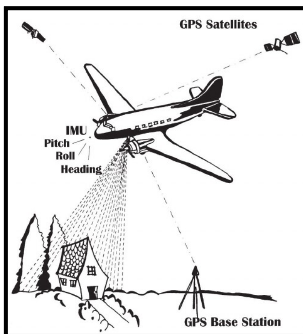
Obr. 1: Princíp leteckého laserového skenovania, zdroj: Hanus a Kasper, 2013.
